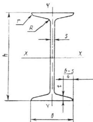
$h$  — высота двутавра;  $b$  — ширина полки;  $s$  — толщина стенки;  $t$  — средняя толщина полки;
