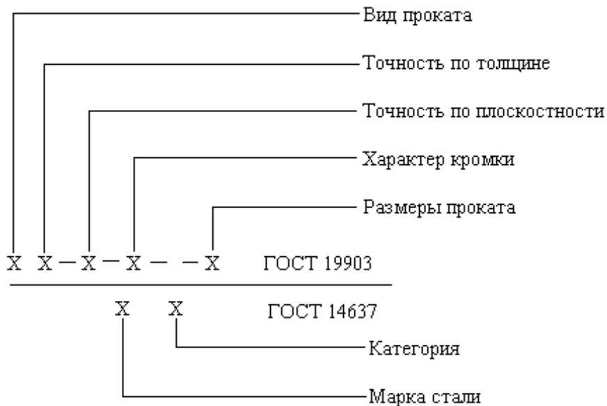
Примечание. Параметры и характеристики проката приведенные в схеме, если они не указаны в заказе, устанавливаются изготовителем и в обозначении не приводятся.
